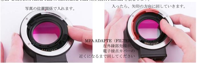
④、EF-E MOUNT ADAPTER に EF マウントレンズを装着し、E マウントカメラに装着し、撮影準備完了です。
